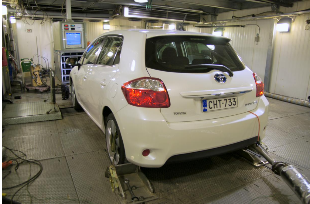
Kuva 3. Henkilöauto alustadynamometrillä VTT:n ajoneuvolaboratoriossa.
