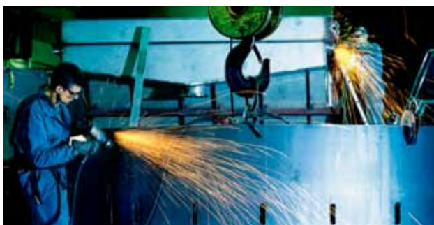
▲ Slipning av cylinderbehållare i rostfri stålplåt.
