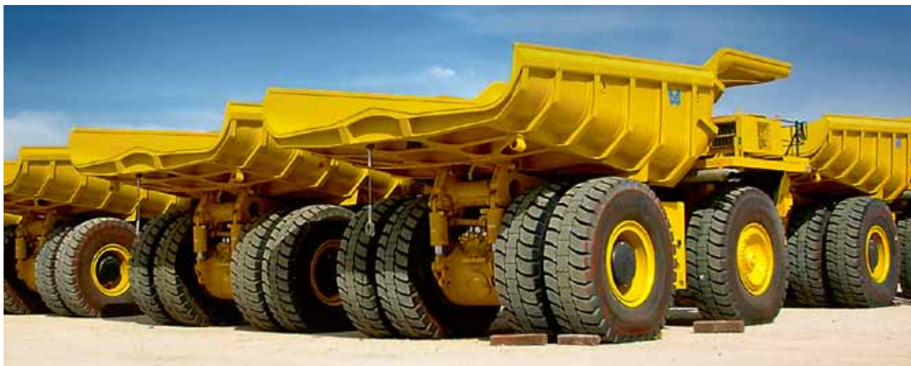
▲ Dumpertrucker med flak av SSABs höghållfasta stål.
