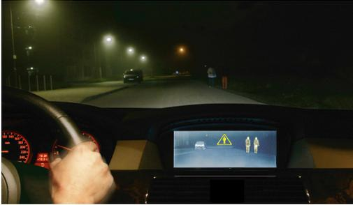
Die Erkennung der Gefahr durch ein Sensor System ist Voraussetzung für die Einleitung des automatischen Bremsvorgangs. Die weiterentwickelte Version des infrarot-basierten Autoliv Nachtsichtsystems, das BMW kürzlich im 7-er auf den Markt gebracht hat, ist ein solches System. Es warnt den Fahrer vor gefährdeten Fußgängern und gibt ihm damit ca. 4 Sekunden Reaktionszeit. Die auf der ESV Konferenz vorgestellte Studie belegt die Bedeutung einer Weiterentwicklung dieses Systems.
